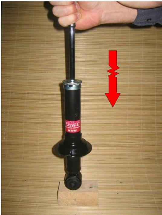
Мы рекомендуем мастерам сервисных станций перед установкой прокачать амортизатор два-три раза. Это позволяет выявить случаи заклинивания клапанного механизма, а также другие случаи неисправности клапанного механизма. Также обращаем ваше внимание на то, что небольшие провалы в сопротивлении клапанного механизма, а также разница в скорости выхода штока в газо-масляных амортизаторах не является неисправностью и никоим образом не отражается на работе амортизатора.
